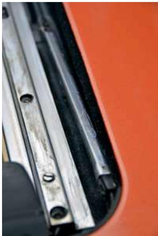
**Bild 18: Gleitschienen und Aufsteller für Windabweiser – frisch gereinigt und geschmiert**
