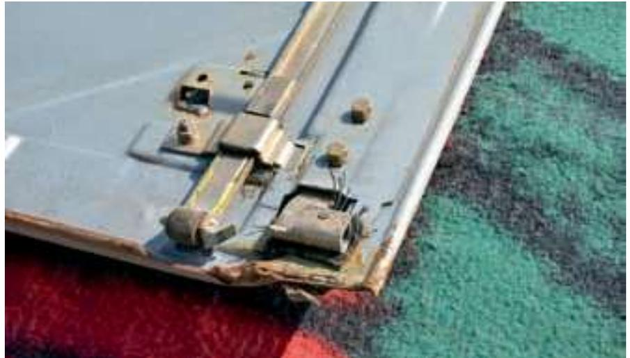
**Bild 17: mechanisches Dach: Gummirolle der Bremsstange und fehlende Gleitbacke**
