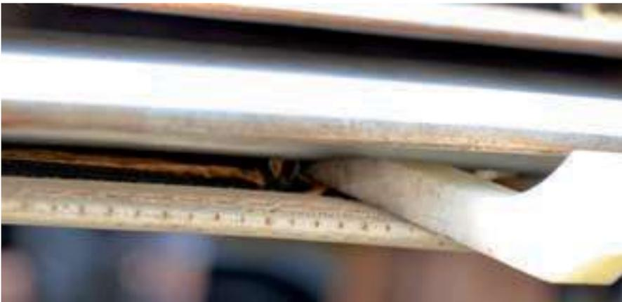
**Bild 5:** Innenverkleidung vom Schiebedachdeckel lösen
