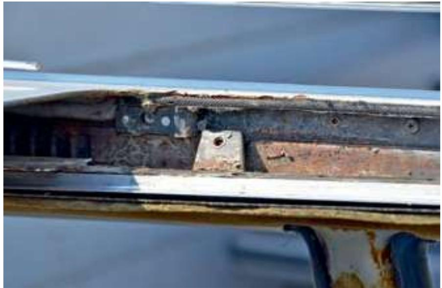
**Bild 2:** Winkel hinten seitlich beim mechanischen Schiebedach, mit Schraube zur Höheneinstellung
