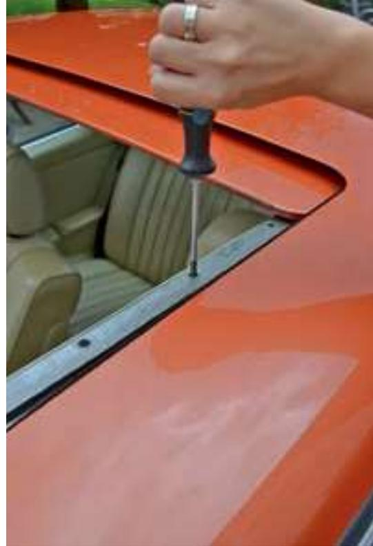
**Bild 8: Kreuzschlitzschrauben der Gleitschienen entfernen**
