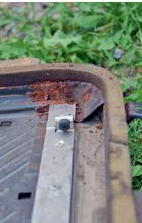
**Bild 20:** Sonst nicht sichtbar: Wasserablauf hinten, hier durch Verstärkungsblech verdeckt
