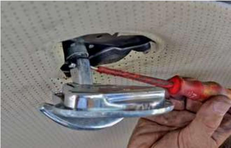
**Bild 4:** bei mechanischen Dach: Griffmulde und Griff entfernen
