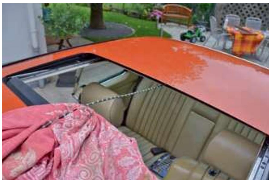
**Bild 21:** elektrisches Dach: mag es auch gerne geschmiert: Seilzug
