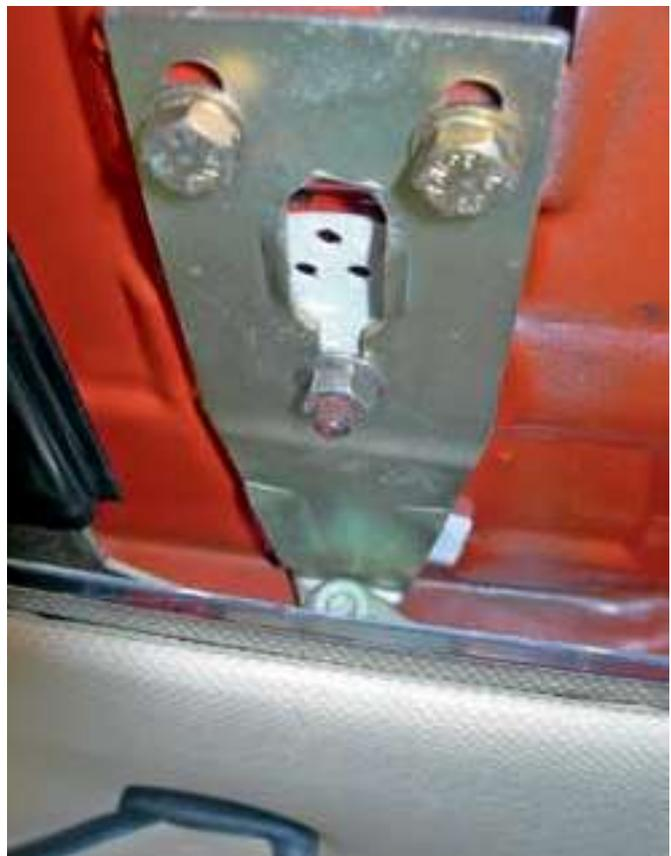
Bild 22: elektrisches Dach: gut versteckt: Höhenverstellung hinten
