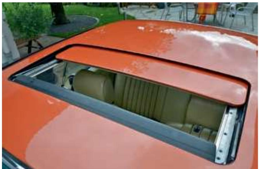
**Bild 3:** 1. Schritt: Dach zu ca. 3/4 öffnen
