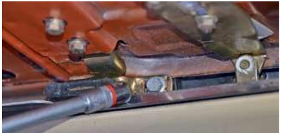
**Bild 10: bei elektrischem Dach: Sechskantschrauben hinten rechts und links entfernen, SW 8**
