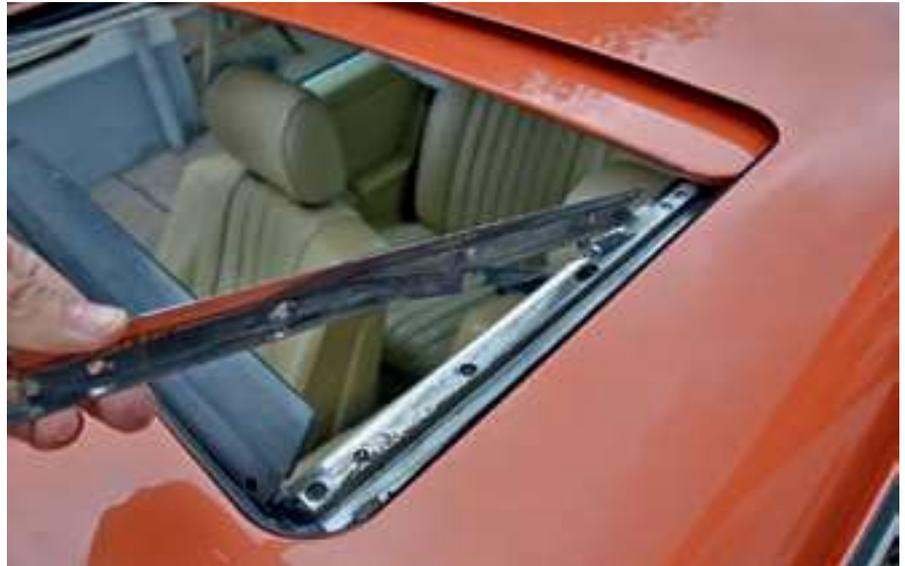
**Bild 9: Oberteil der Gleitschienen abnehmen**
