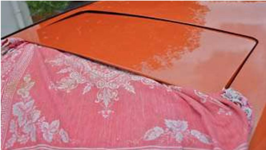
Bild 12: Dach außen abdecken, Schiebedachdeckel nach vorne schieben und nach oben herausnehmen
