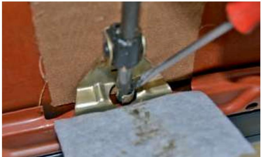
**Bild 11: bei elektrischem Dach: Sicherungsbolzen des Seilzugs vorne entfernen und anschließend Seilzug nach hinten laufen lassen**
