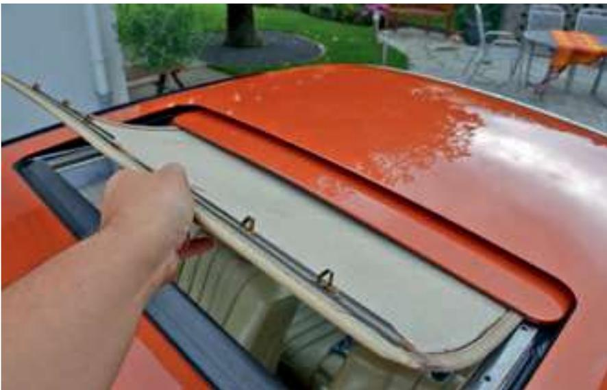
**Bild 7:** Innenverkleidung nach vorne und oben herausnehmen
