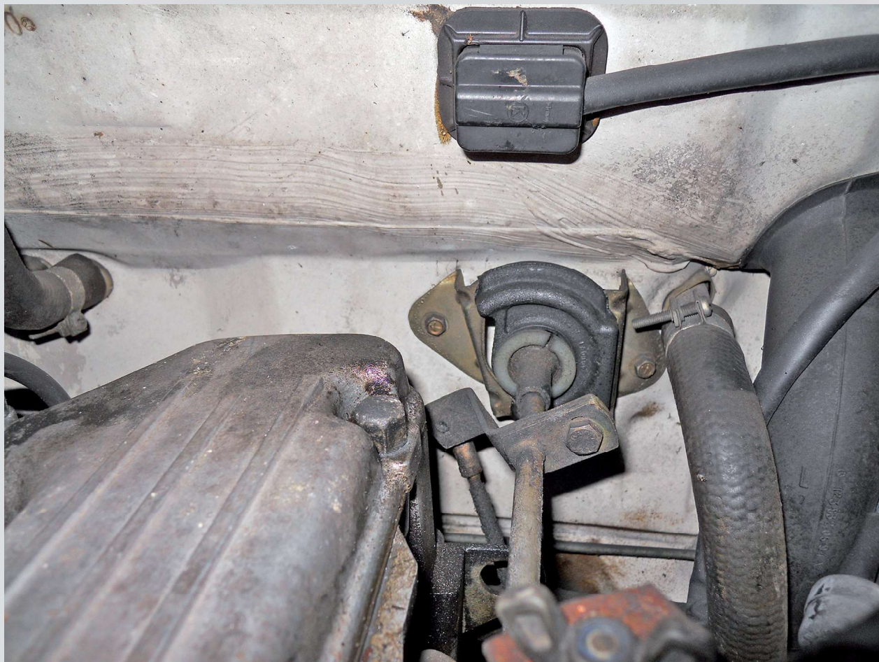
Bild 4 (oben): Halter des Gasgestänges an der Stirnwand, erste Ausführung für M110 (bis 123 033 ... 079587)
