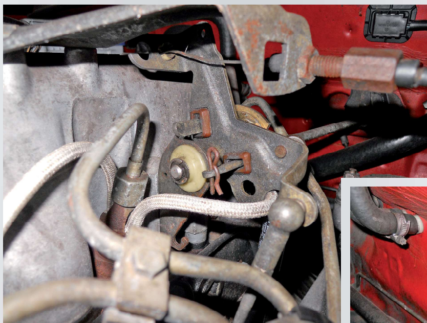
Bild 8: Beide Diesel-Lagerbuchsen aus entgegengesetzter Blickrichtung. Die Bilder zeigen anschaulich, wie die Lasche A110 070 0038 anzupassen (bzw. zu zerschneiden) ist, um hier im Schadensfall für Abhilfe zu sorgen.
