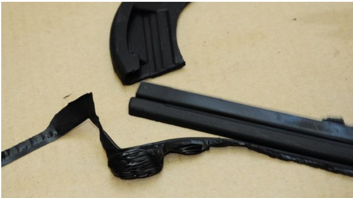
Entgraten: Hier ist Handarbeit angesagt – bei hunderten gefertigten Leisten ein zeitaufwendiger Produktionsschritt.
