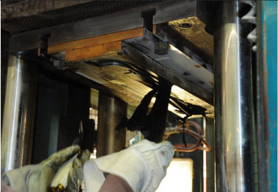
Entnahme der Spritzlinge aus der Form.
