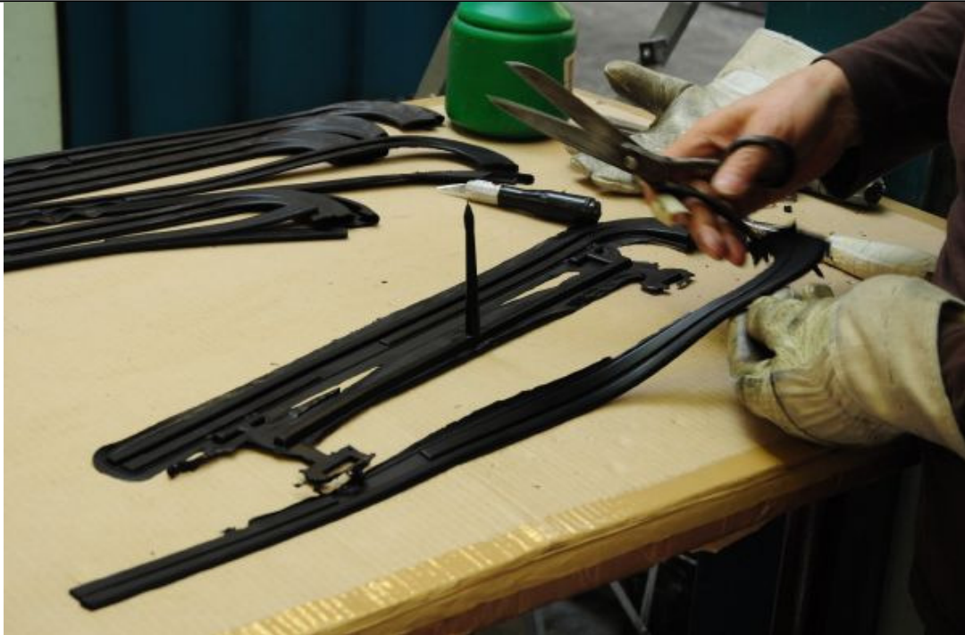
So sehen die Rohlinge aus. Der Glanzgrad orientiert sich an den Neuteilen A123 968 0630 (Regenleisten).
