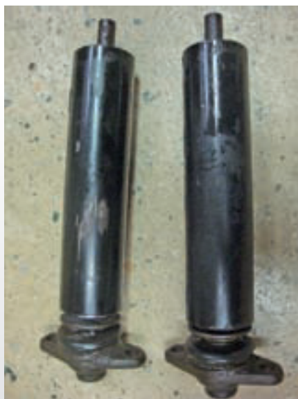
Dämpfer S123 Niveau im stark gebrauchten Anlieferzustand
