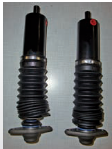
Dämpfer S123 im überholten Zustand mit neuen Gelenken
